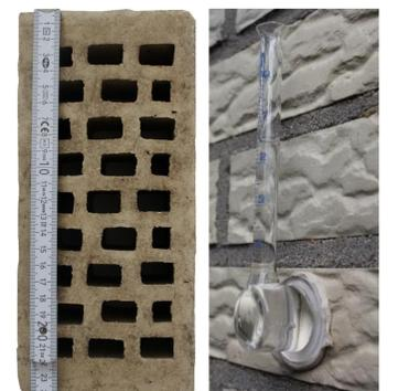
Abb. 3: Klinker (l.), Prüfrohr (r.) (eigene Abbildung)
